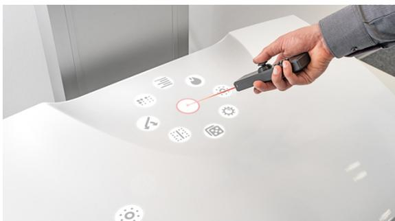
**Der Multimodale Dialogassistent für die manuelle Qualitätskontrolle in der Industrie kann per Sprache oder Gesten gesteuert werden. (© Fraunhofer CCIT/Fraunhofer IAIS)**
