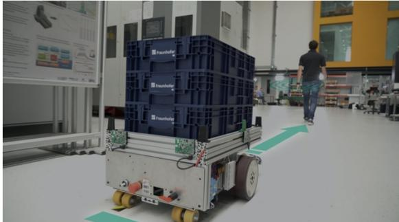
**Flexloc: flexible, selbst einmessende Lokalisierungslösung für automatisierte Produktions- und Logistikprozesse. (© Fraunhofer CCIT/Fraunhofer IIS)**
